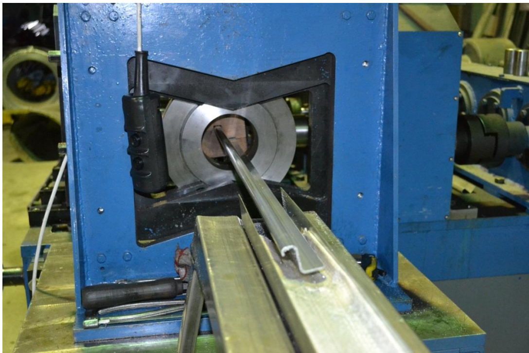
Рис.4 Готовый профиль «Стрингер», соответствующий заданным требованиям формы и размеров в рабочей зоне штампа
