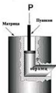
Рис.1 Схема процесса РКУП
