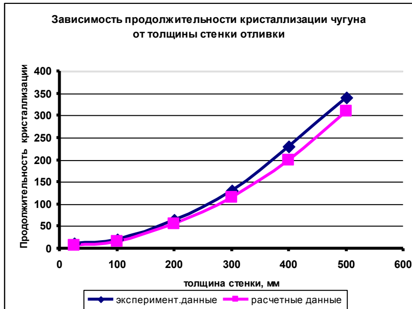
Рис.2 Зависимость продолжительности кристаллизации чугуна от толщины стенки отливки.
