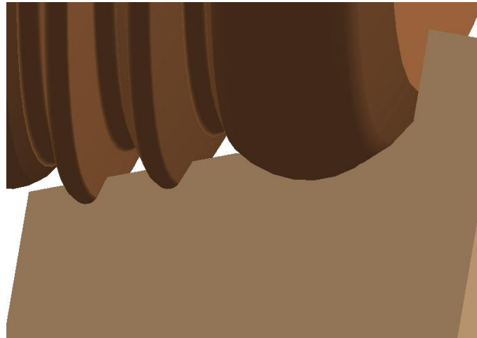
Рис. 5. Модель первого прохода профильного глубинного шлифования
