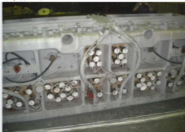
Рис. 18 Кристаллизатор со смонтированными УЗ излучателями
