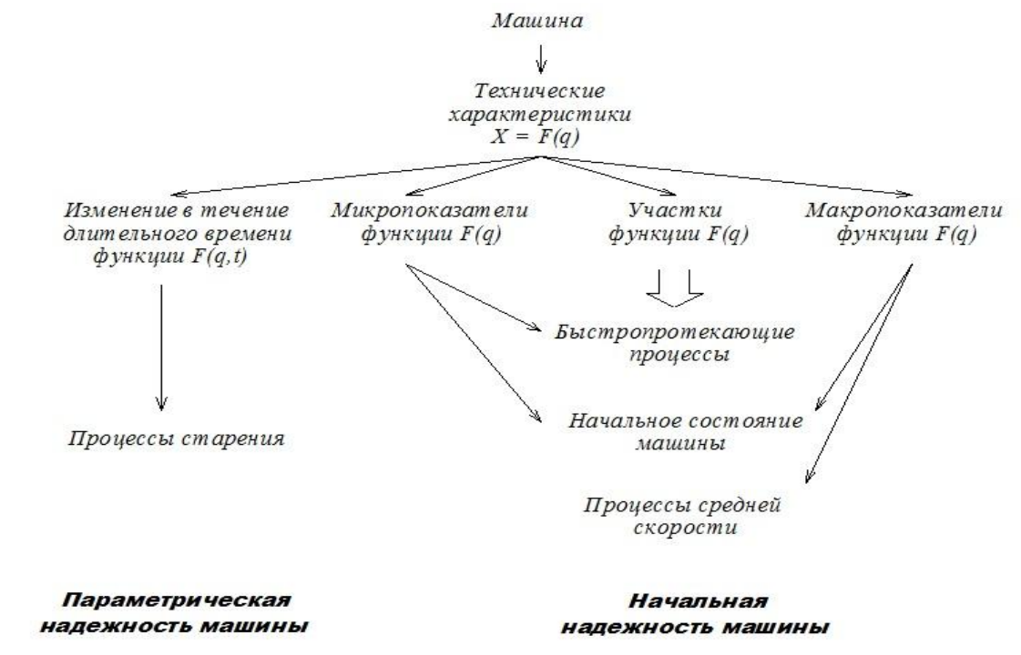
Рис. 2 Выходные параметры станка, как числовые показатели его технических характеристик
