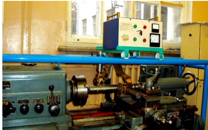
Рис. 2. Фрагмент размещения «Колибри» на токарно-винторезном станке 1К62
