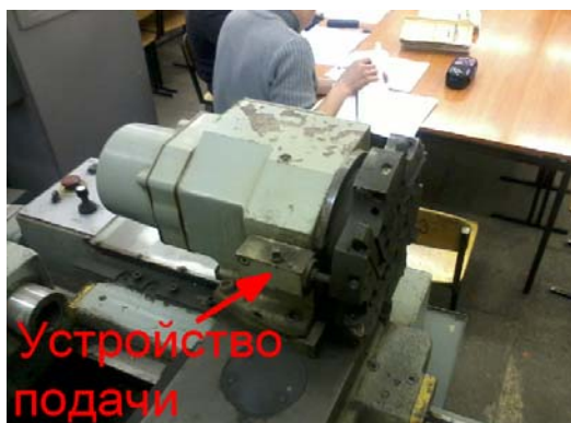
Рис. 2. Револьверная головка УГ9321
