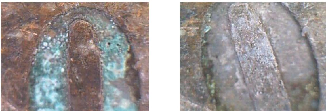
Рис. 2. До и после лазерного воздействия на окисленную поверхность меди
