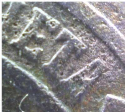
Рис. 5. Микроплавление поверхности при уменьшении диаметра пятна 0,2 мм
