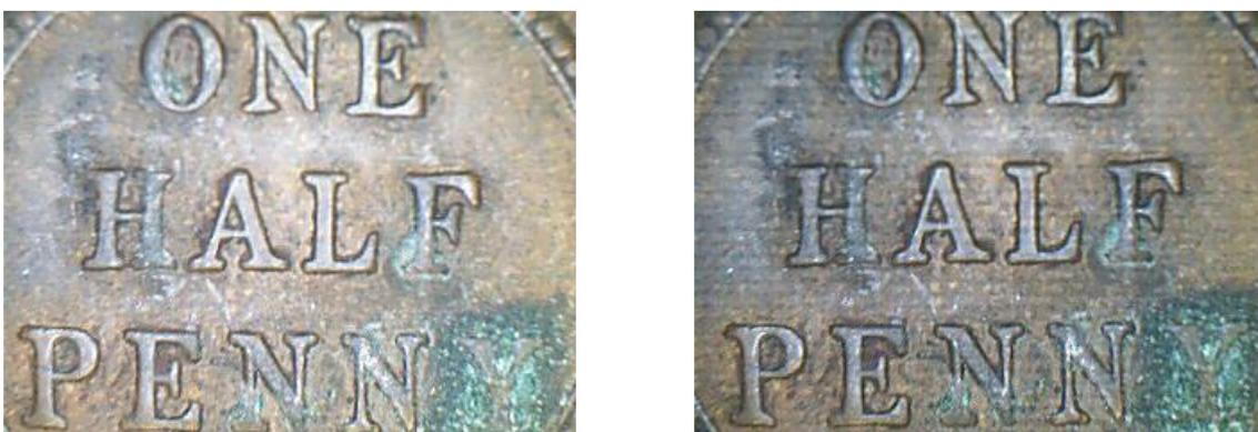
Рис. 4. До и после лазерного воздействия на поверхность окисла при минимально возможной длительности импульса на данной установке
