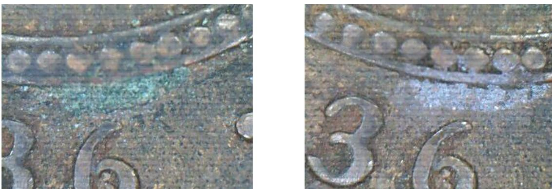
Рис. 3. До и после лазерного воздействия на окисленную поверхность меди
