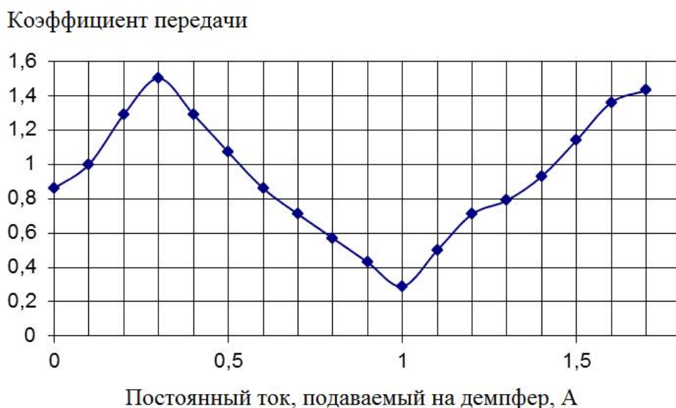
Рис. 2. График зависимости коэффициента передачи амплитуды колебаний демпфера на основе МР – эластомера
