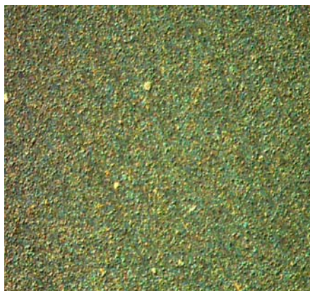
Рис.1. Микроструктура стали 14ХГС после 50 лет эксплуатации (цифровой микроскоп Dino-Lite Digital Microscope AM-311 с разрешением 640x480 пиксель)
