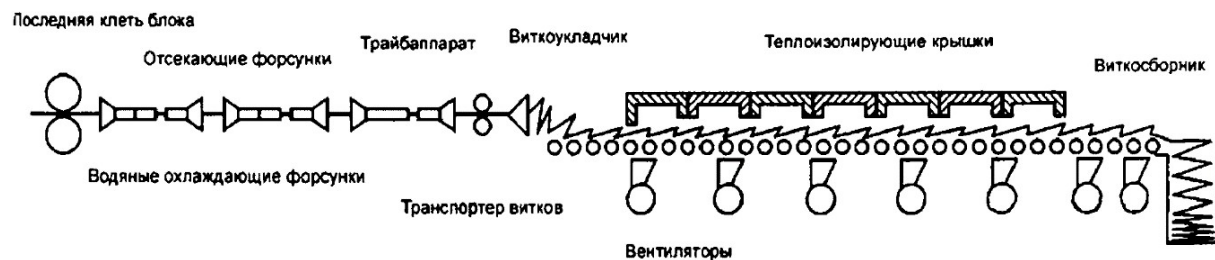
Рис. 1. Линия двустадийного охлаждения Stelmor
