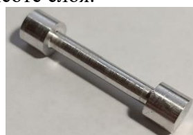
Рис. 3 – Внешний вид и размеры образца выращенного для испытания на растяжение
