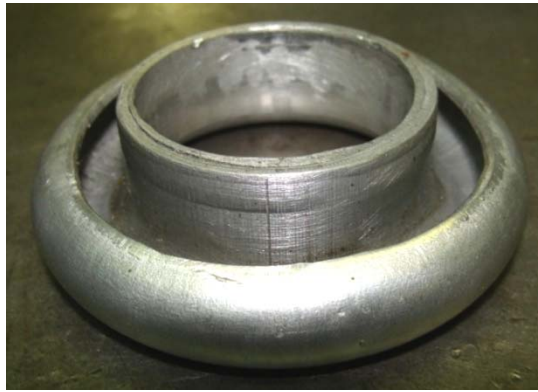
Рис. 3. Штампованная трубная заготовка после выворота в результате равномерной раздачи по пуансону без применения матрицы.
