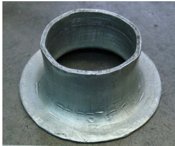
Рис. 6. Плоский фланец, полученный на трубной заготовке экспериментально раздачей с применением матрицы.
