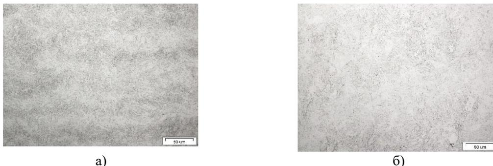
Рисунок 1 – Микроструктура высокоазотистой стали при увеличении  $\times 500$  после закалки с температуры: а) 900 °С; б) 1100 °С
