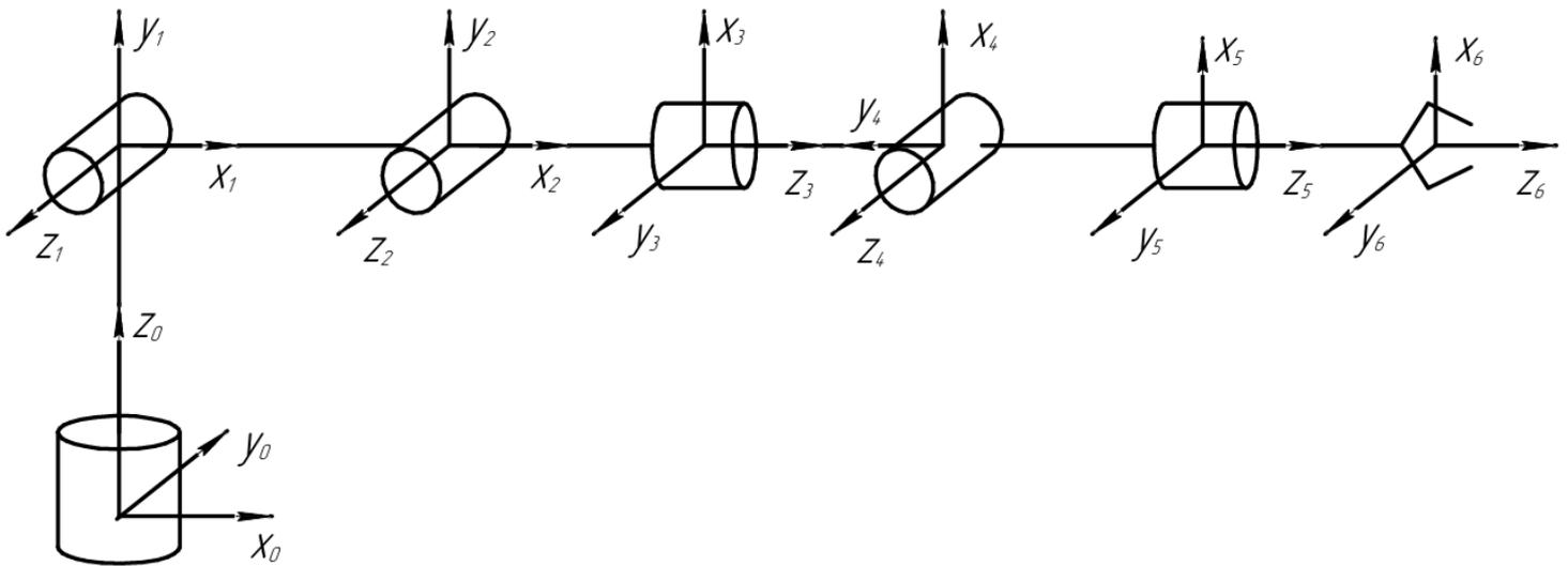
Рис. 2.1. Кинематическая схема с выбранными системами координат
