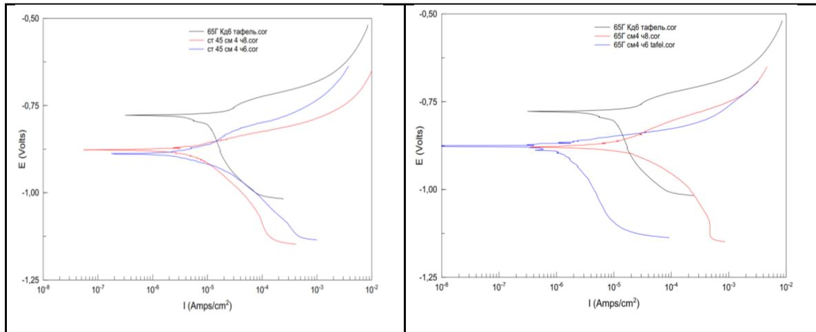
Рис. 2. Кривые, полученные методом линейной вольтамперометрии, для образцов с ТД покрытием на основе Al-Zn с термообработкой при температуре 420 °С в течение 6 и 8 ч.
