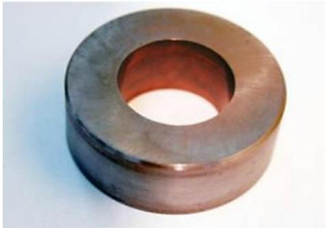
Рис.3 Деформирующая фильера, покрытая «сервовитной плёнкой» после обработки в среде металлоплакирующей смазки.
