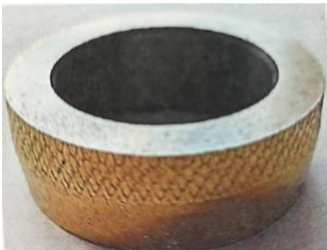
Рис.1 Деформирующий элемент по патенту РФ №2560477 с регулярным микрорельефом и износостойким покрытием.
