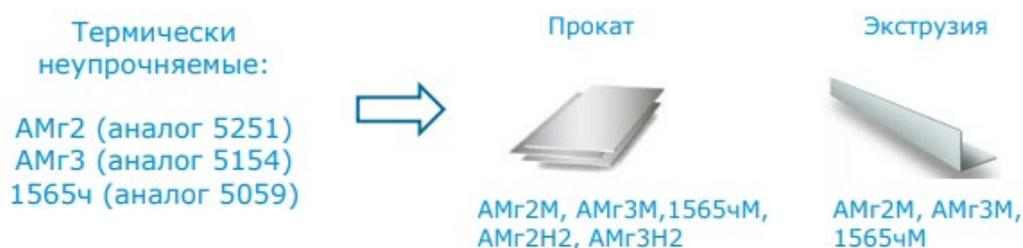
Рис. 1 Алюминиевые сплавы и виды полуфабрикатов для мостов
