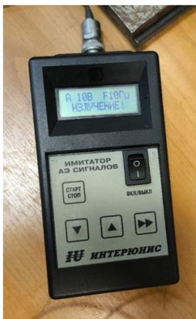
Рис. 5. Имитатор АЭ сигналов
