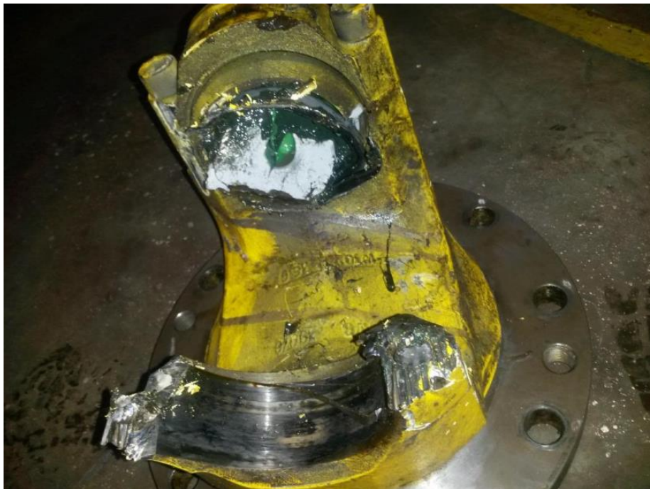
Рис. 1. Разрушение корпуса крестовины шпинделя
