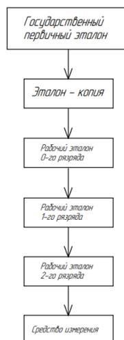
Рис. 2 - Общая поверочная схема эталона температуры
