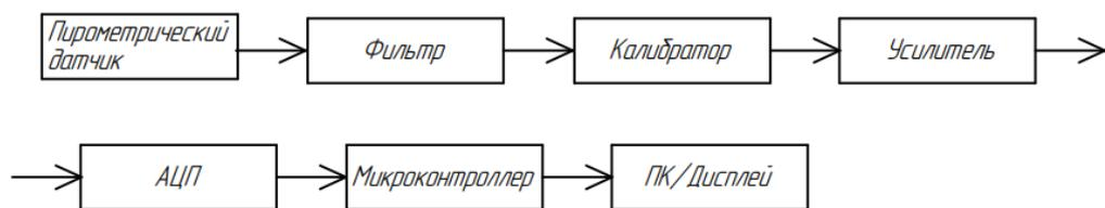
Рис.1 – Измерительный канал пирометрического датчика
