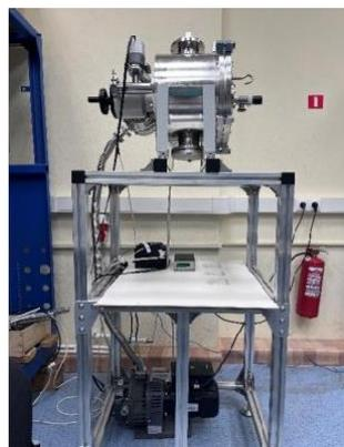
Рис. 1. Вакуумная принципиальная схема и внешний вид стенда для определения газовыделения мишеней
