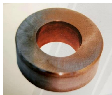
Рис. 2 Деформирующая фильера с РМР поверхности рабочего канала, полностью покрытая «сервовитной» пленкой после волочения в среде металлоплакирующей смазки.
