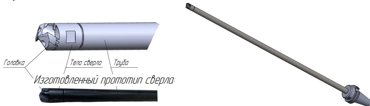
Рис. 1. Модели и прототип нового сверла
