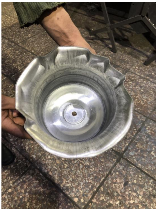
Рис.4 – Гофрообразование на изделии
