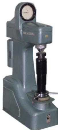
Рис. 10. Стационарный твердомер Роквелла ТК-2М
