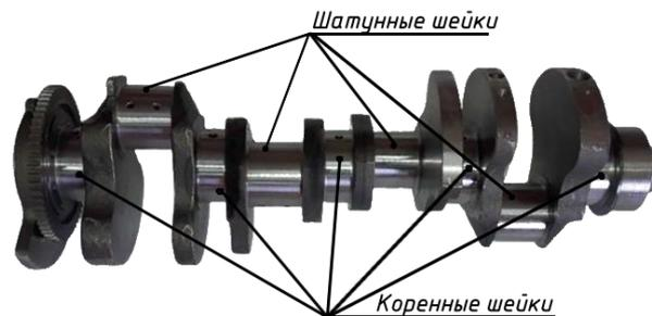
Рис. 1. Коленчатый вал двигателя КамАЗ 740
