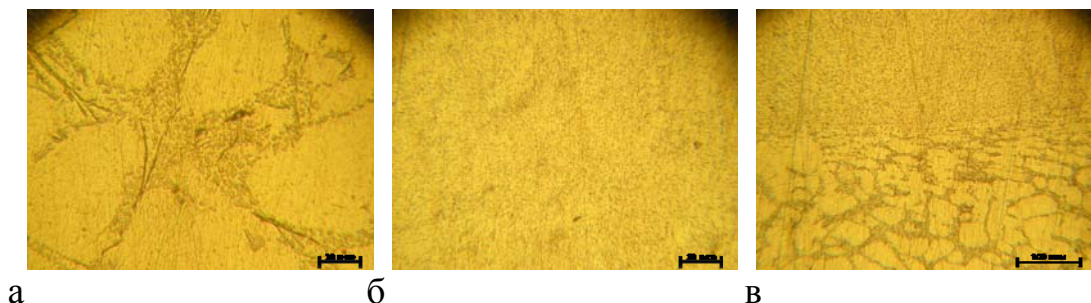
Рис. 1. Микроструктура АЛ4: а) до перемешивания, б) после перемешивания, в) на границе двух областей
