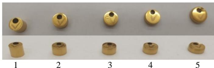
Рис.1. Образцы с износостойким покрытием TiN
