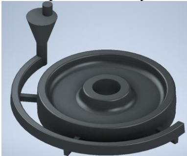
Рис. 1. Исходная литниково-питающая система с отливкой
