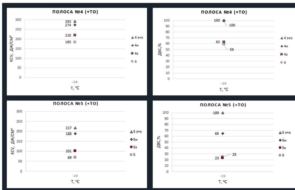
Рисунок 6 – значения ударной вязкости и ДВС образцов до и после термообработки.
