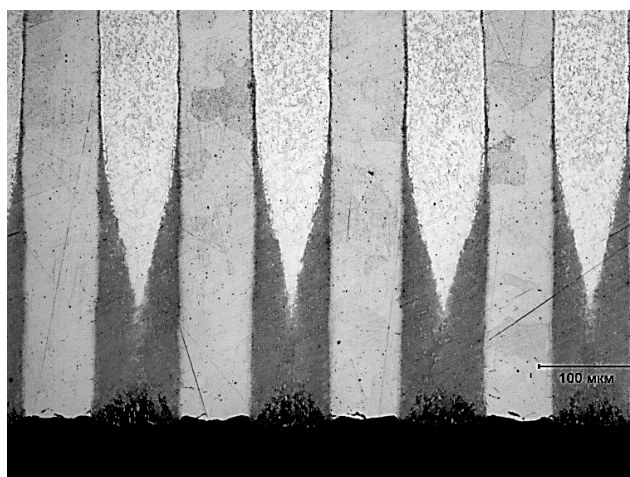
Рис. 1. Микроструктура азотированного слоя образцов композиции 08кп+08X18H10
