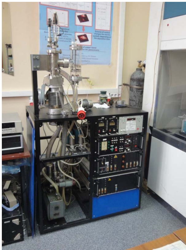
Рис.5. Вакуумная установка модульного типа
