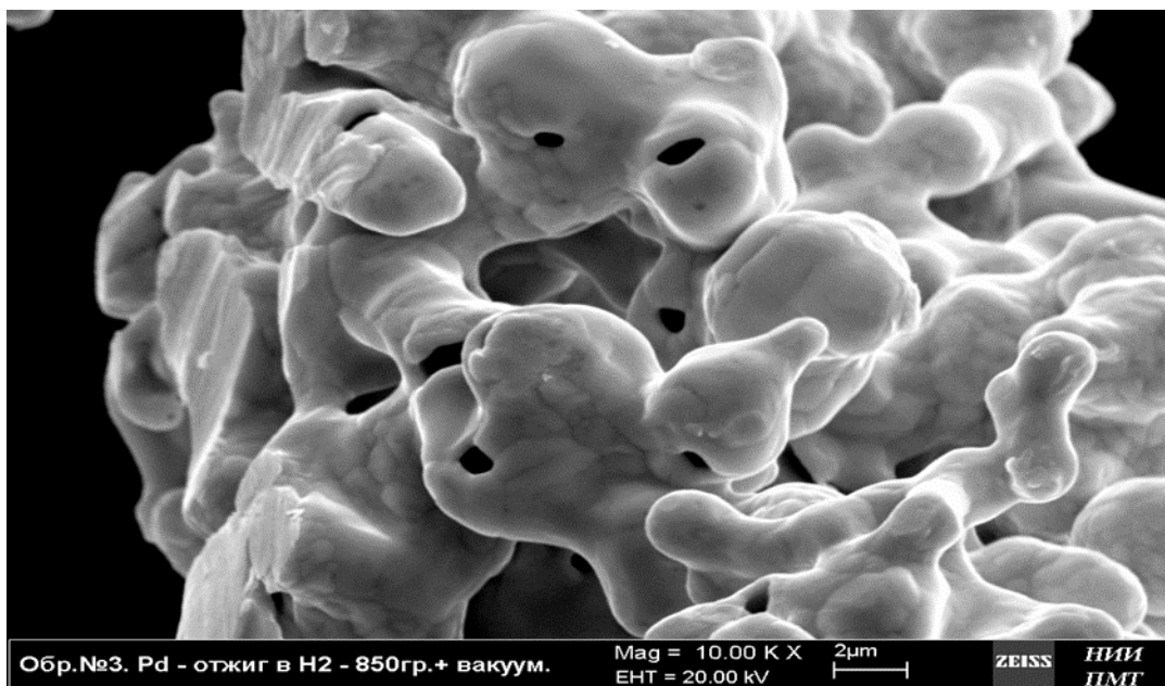
Рисунок 2. Микрофотография исходного порошка палладия второй группы в вакууме после термической обработки
