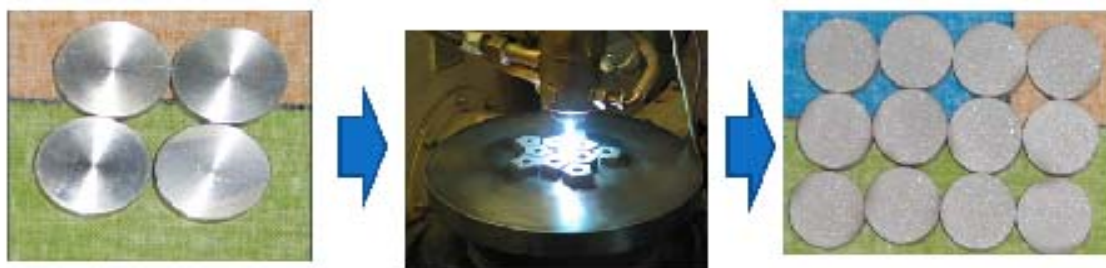
Исходные образцы(Сталь 3 и Д16) – диаметр 20мм, h16мм.
