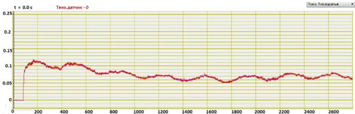
Рисунок 3. График изменения коэффициента трения от времени для образца № 1.
