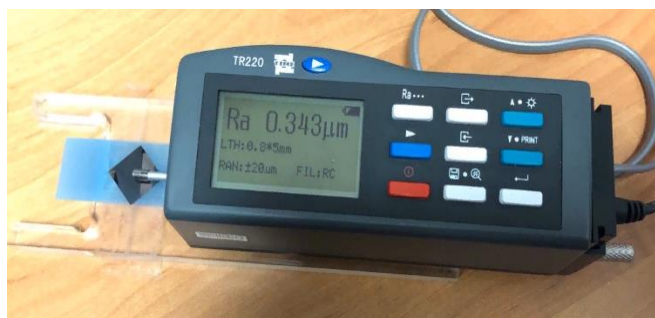
Рисунок 4. Сканирование поверхности образца профилометром TR220
