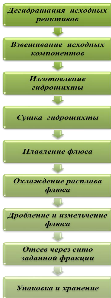
Рис. 1. Технологическая схема изготовления опытных партий флюса для пайки алюминиевых сплавов
