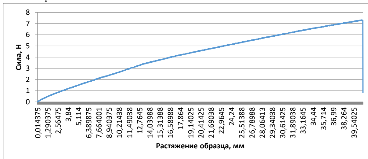
Рисунок 2 – График зависимости силы от растяжения образца
