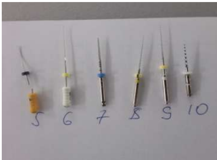
Рис. 2. Инструмент обработки корневого канала, образцы из аустенитной нержавеющей стали
