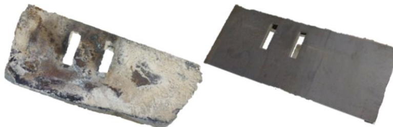
Рис. 1. Изношенный и новый скребок
