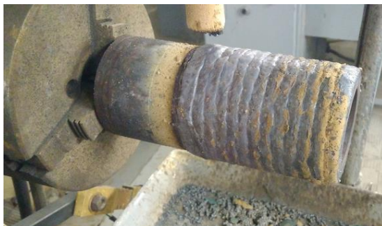
Рис. 2. Наплавленная поверхность цилиндра
