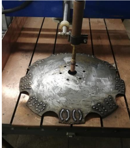
Рис.2. Упрочнённый диск бороны
