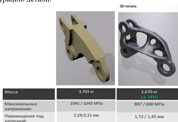
Рис.1. Оптимизация геометрии детали средствами аддитивных технологий
