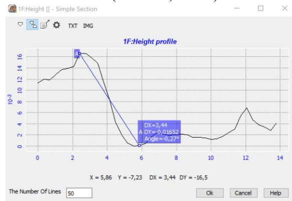
Рис. 5 Измерение ступеньки образца 4 – 17 нм ( h=60 мм, t=60 с)
