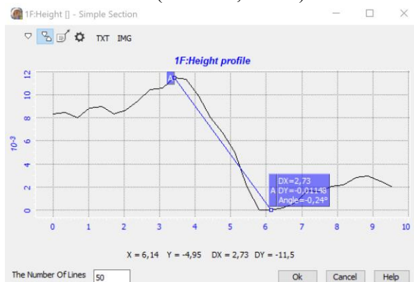
Рис. 4 Измерение ступеньки образца 3 – 13 нм ( h=60 мм, t=30 с)
