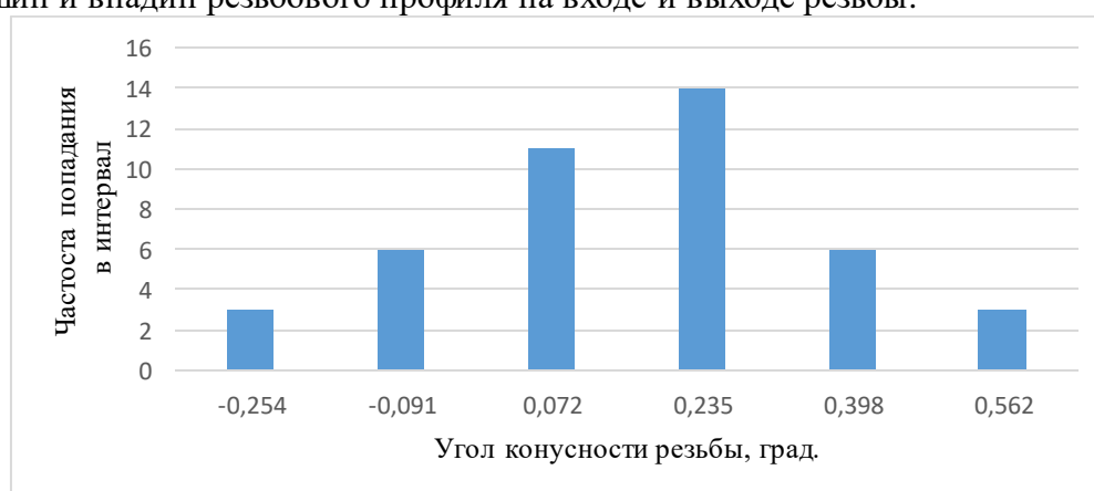
Рис. 1. Гистограмма распределения углов конусности резьбы.
