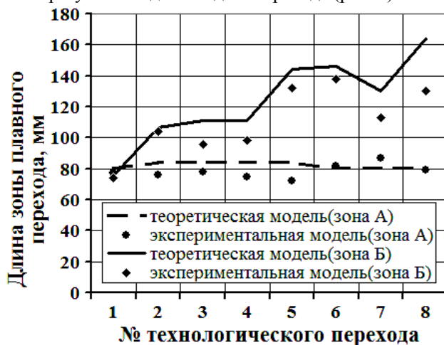
Рис. 2 Сравнение теоретических и экспериментальных данных по определению протяженности ЗПП
