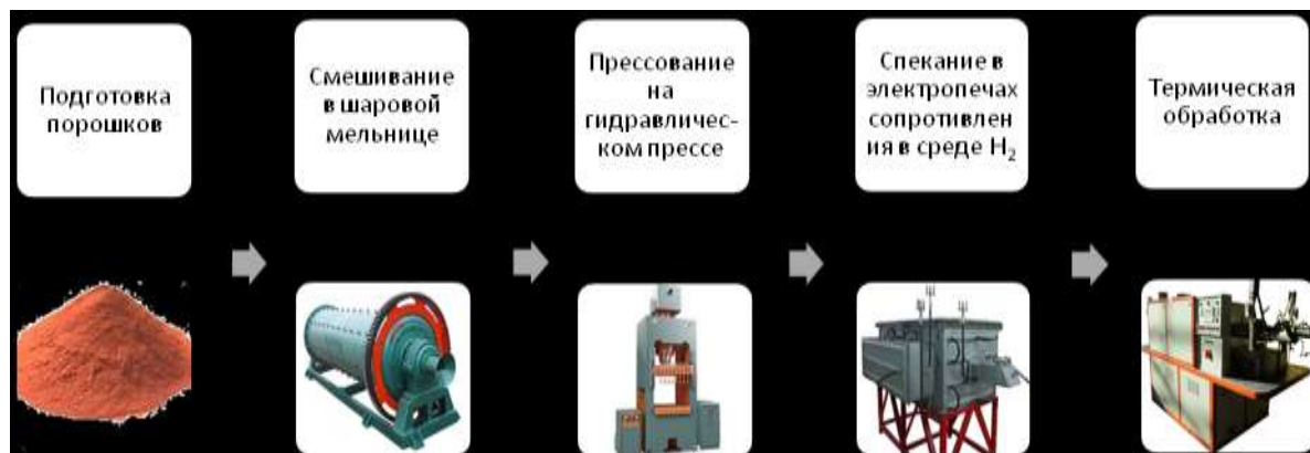
Рис. 1. Схема производства металломатричных композитов системы медь-молибден
