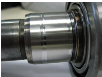
Рис. 1. Износ шейки вала
