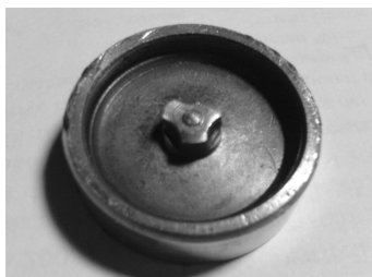
Рис 5. Испытание на прочность по Бринеллю каленым шариком с обратной стороны точной заготовки детали «Дно». 1 – в центре; 2 – на периферии.
