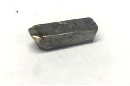
Рис. 2 Внешний вид алмазного резца
