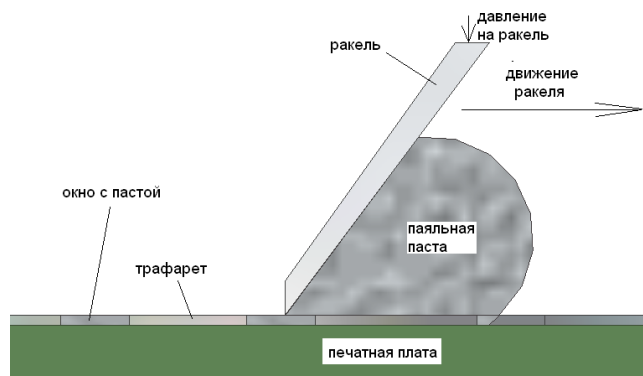
Рис 3 – Схема нанесения пасты трафаретным методом показана [3]
